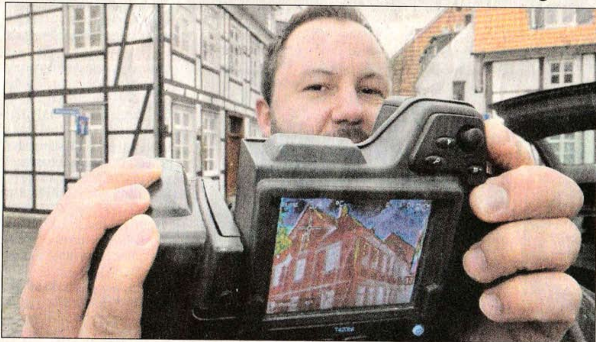
Patrick Klode fertigt die Thermo-Aufnahmen an. An den Farben lässt sich gut ablesen, wo Wärme buchstäblich flöten geht und wo Bauten ordentlich isoliert sind. ■ Foto: Dahm
